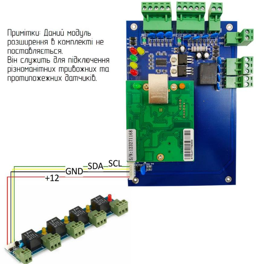
Примітки: Даний модуль розширення в комплекті не поставляється. Він служить для підключення різноманітних тривожних та протипожежних датчиків.
